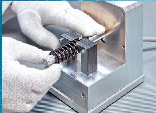
links: Prüfung von Ventulfedern mit vollautomatisiertem und manuellem (rechts) Ventulfederscanner
