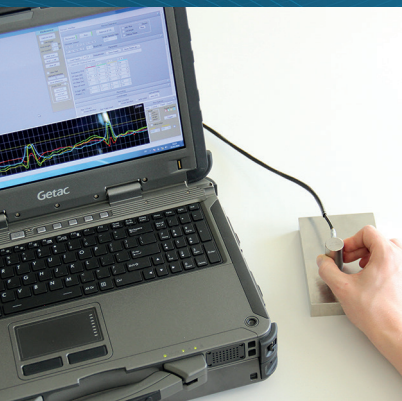
Links: Mobiles Wirbelstromprüfsystem; rechts: Kundenspezifisches Vielkanalprüfsystem
