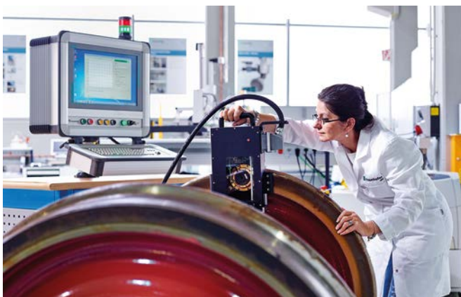
Ermittlung der Eigenspannungen an Güterwagenrädern © Uwe Bellhäuser
