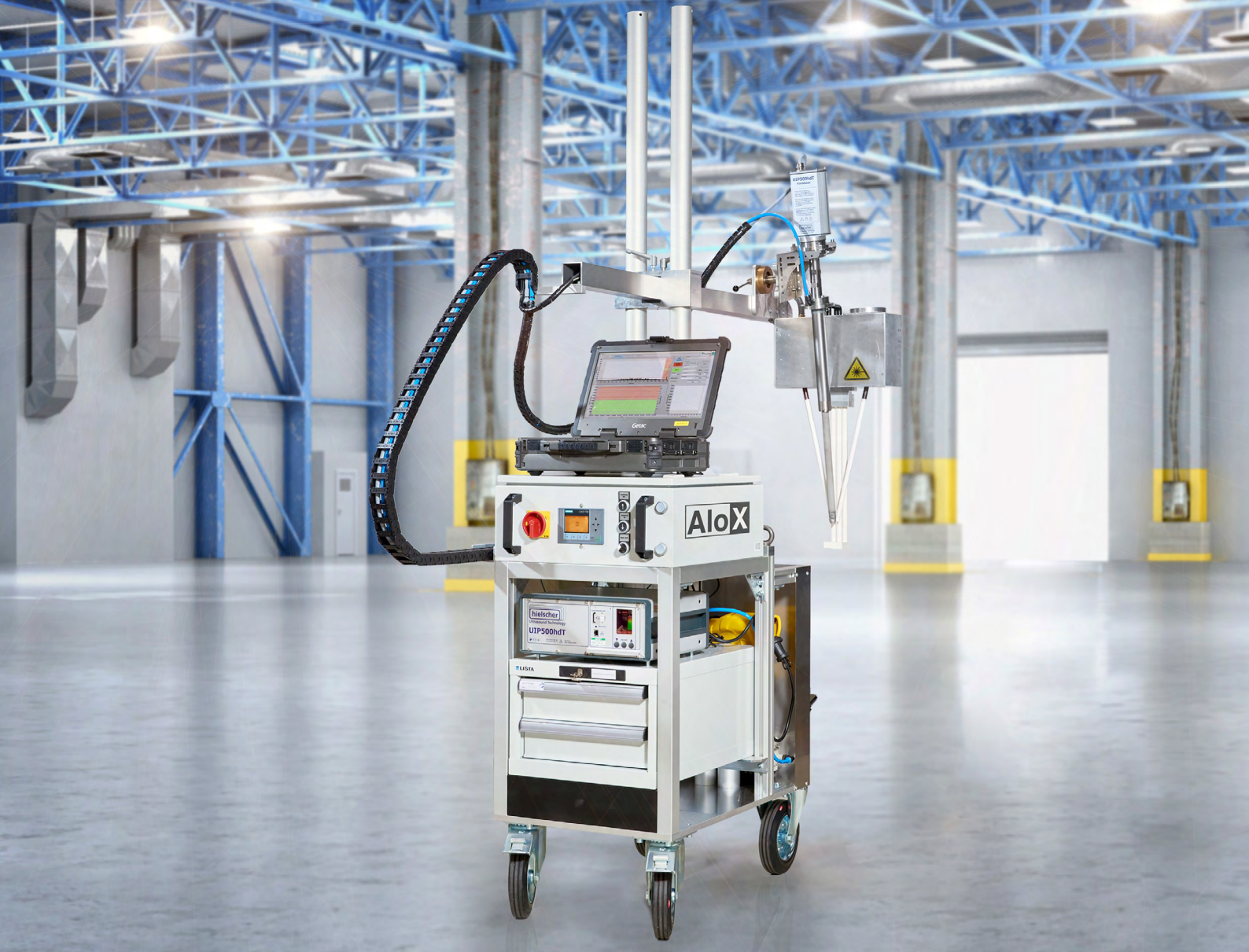
Ultraschallbasiertes Messsystem zur Bestimmung von Einschlüssen in Aluminiumschmelzen; Copyright: Uwe Bellhäuser
