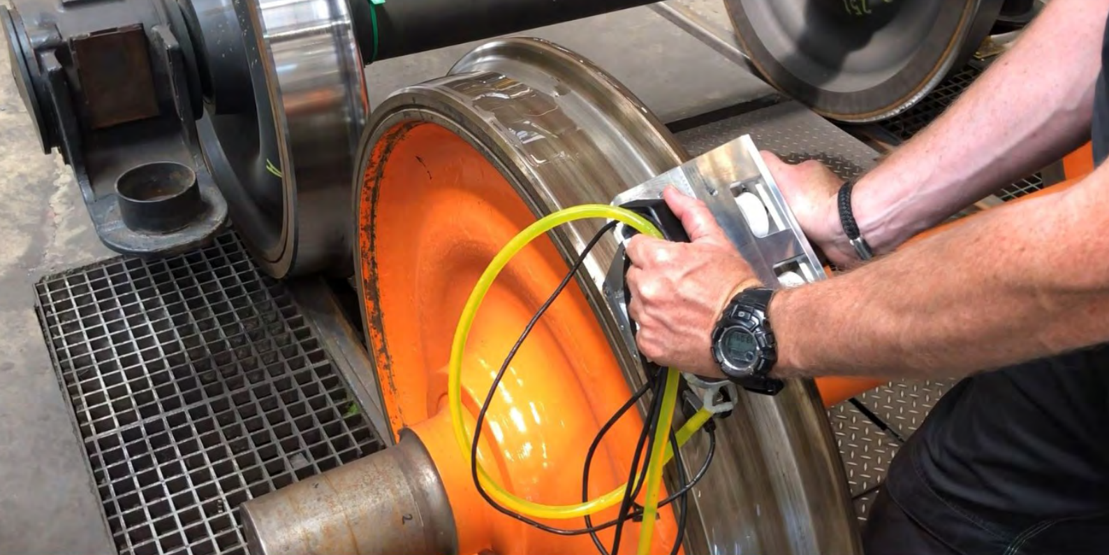
Ultraschall-Laufflächenprüfung unter realen Bedingungen; Copyright: Fraunhofer IZFP
