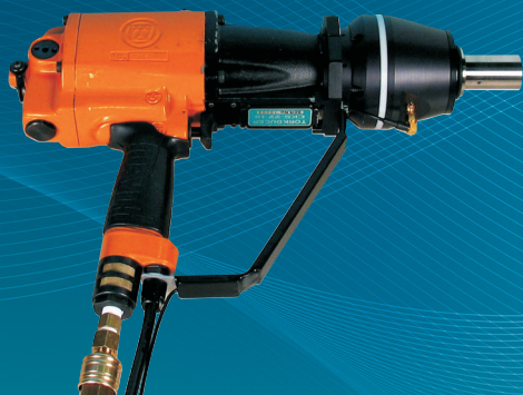
Links: Handelsüblicher Pulsschrauber plus Ultraschallnuss und Signalübertrager; rechts: Handelsübliche Schrauben
