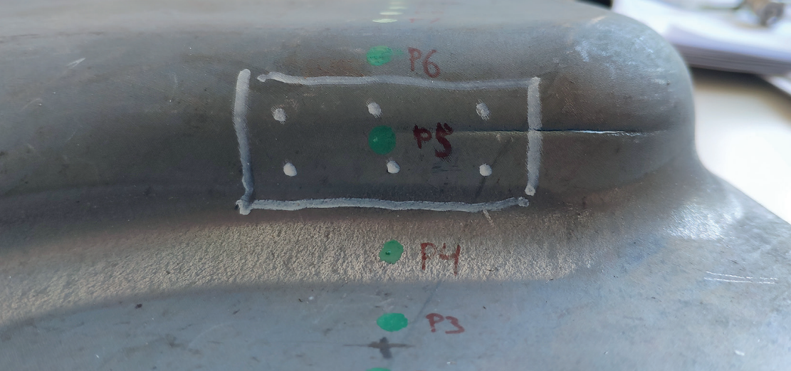
Umformblech mit Einschnürung bis zum Riss
