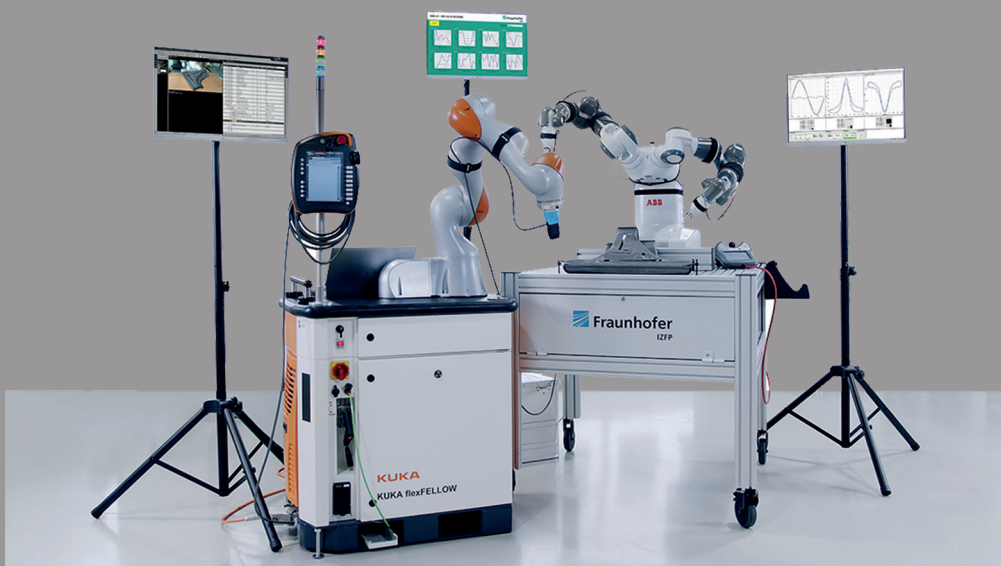
OPC UA-Demonstrator: Mittels OPC UA koordinierte Prüfaufgabe an einem industriellen Bauteil mit drei Sensortypen (Wirbelstrom, Ultraschall und 3MA II) sowie gemeinsamer Ergebnisdarstellung und Dokumentation im DICONDE-Format
