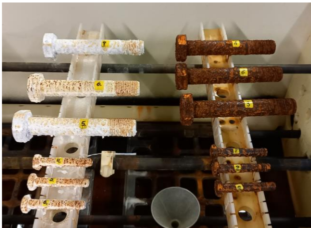
Abbildung 5-15: Feuerverzinkte (links) und unbeschichtete (rechts) HV-Schrauben M16x100 und M36x220 nach 14-tägiger Auslagerung in einer Salzsprühnebelkammer
