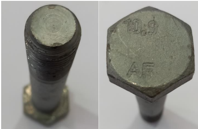
Abbildung 5-19: Oberflächen der Kuppe (links) und des Kopfes (rechts) der verwendeten HV-Schrauben
