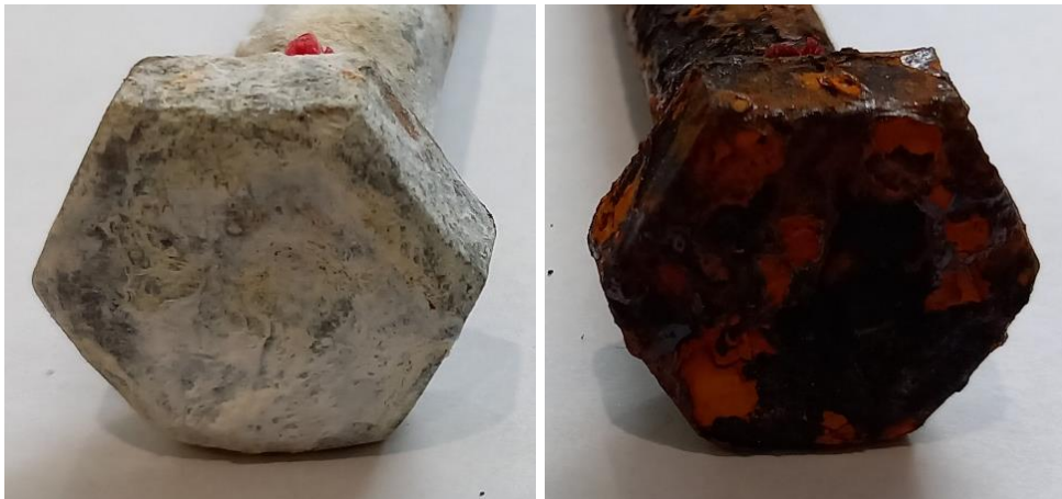
Abbildung 5-17: Oberflächen der Köpfe der verwendeten HV-Schrauben nach 14-tägiger Auslagerung in einer Salzsprühnebelkammer. Feuerverzinkte Schraube (links) und unbeschichtete Schraube (rechts).
