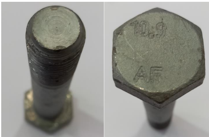
Abbildung 5-10: Oberflächen der Kuppe (links) und des Kopfes (rechts) der verwendeten HV-Schrauben
