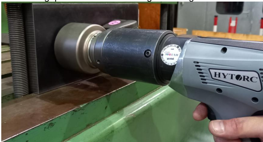
Abbildung 5-21: Montage der HV-Schrauben M36x120 mit Akku-Drehmomentschrauber der Firma HYTORC
