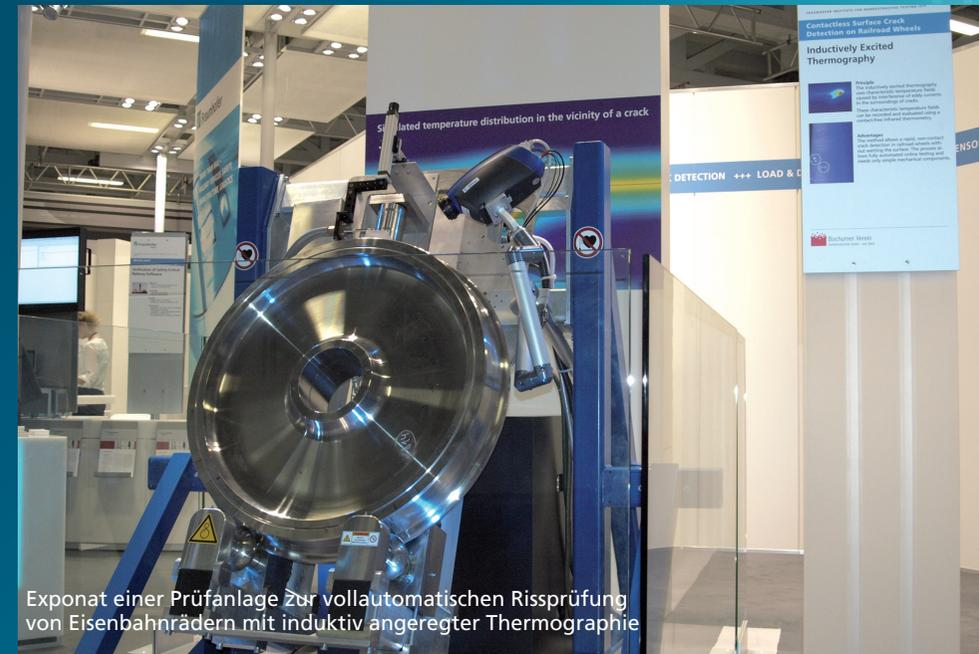
Exponat einer Prüfanlage zur vollautomatischen Rissprüfung von Eisenbahnrädern mit induktiv angeregter Thermographie
