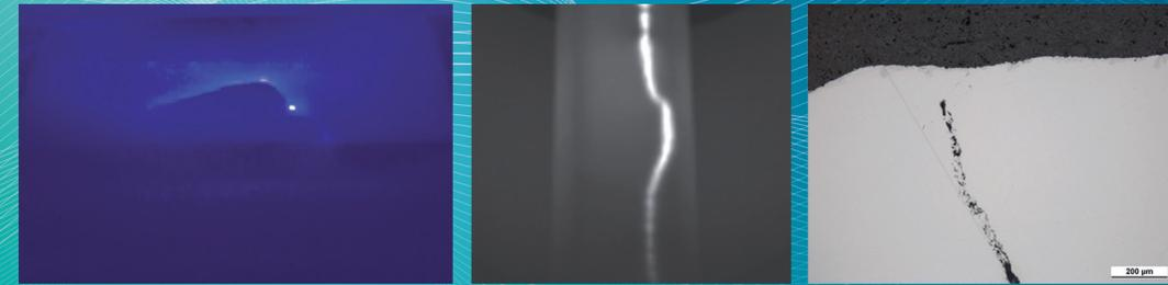
Links: Eisenbahnschiene mit Squat (schräg einlaufender Riss); Mitte: Verdeckter Riss in Stahl; rechts: Verdeckter Riss im Schlibbild
