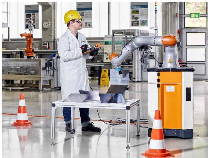
Durchführung einer robotergestützten Prüfung von Stahlplatten. Untersucht werden mechanische Eigenschaften (u. a. Eigenspannungen) mittels mikromagnetischer Verfahren (3MA). © Fraunhofer IZFP / Uwe Bellhäuser Bild in Druckqualität unter: www.izfp.fraunhofer.de/de/Presse/pressefotos.html
